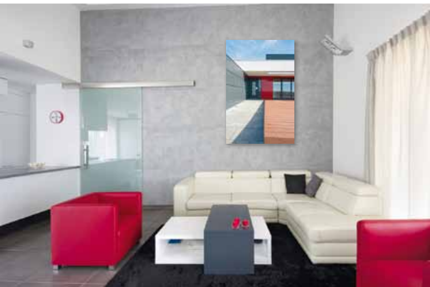
Celý interiér je laděn do bílé, šedé a červené. Do společné obývací části architekti navrhli posuvné dveře z mléčného skla, horní pojezd kryje hliníková lišta
